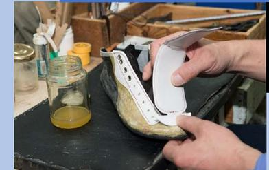
SSSのスケート靴は、ベテランの靴職人により足の寸法と取りから靴型製作を行い、お客様にフィットした靴をお届けすることをモットーとしております。石膏型をもとにカーボンソールを製作するため、力学的に計算されたスケート靴を生み出すことに成功しました。
